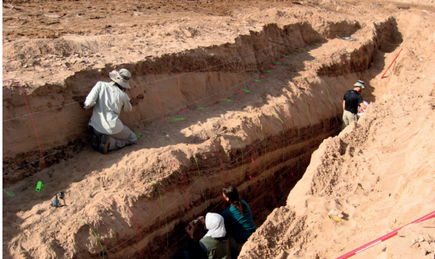
Snímek zachycuje Petru Štěpančíkovou a její kolegy při práci v paleoseismologických rýhách v terénu jižní Kalifornie. Paleoseismologie zkoumá dávná zemětřesení na povrchu i těsně pod ním.
