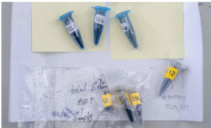
Vzorky nanostrukturních materiálů určené pro stanovení porozity (objemu pórů) pomocí fyzikální adsorpce
